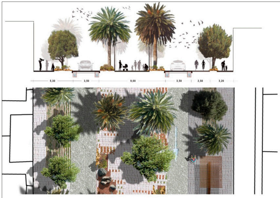
Figura 13. Planta y sección propuesta para uno de los tramos de la Rambla de los Menceyes. Fuente: elaboración propia.
