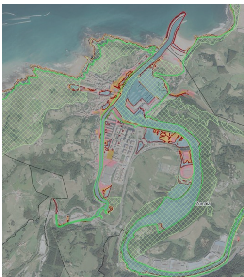
Imagen 8. Infraestructura Verde en Zumaia superpuesta con la inundabilidad por la máxima marea viva equinoccial en los diferentes escenarios (azul estado actual, línea roja año 2045 RCP 4.5 y 8.5, amarillo RCP 4.5 en el 2100 y rosa RCP 8.5 en el 2100).
