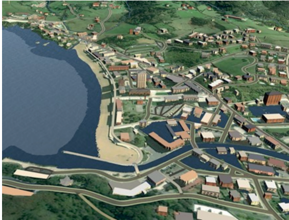
Imagen 1: Playa de Bakio. En azul claro se representa la inundación en el estado actual y en azul oscuro la inundación en el escenario RCP 8.5 del año 2100
