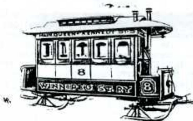
Vagón construido por Stephenson sobre patines para circular por Manitoba.
