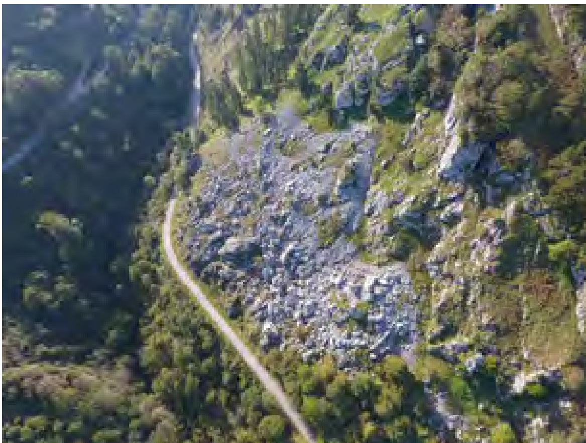
Figura 4. Imagen aérea de un desprendimiento que afecta a las calizas urgonianas del Cretácico, que representan un importante nivel estratigráfico a lo largo de toda la cordillera cantábrica.
