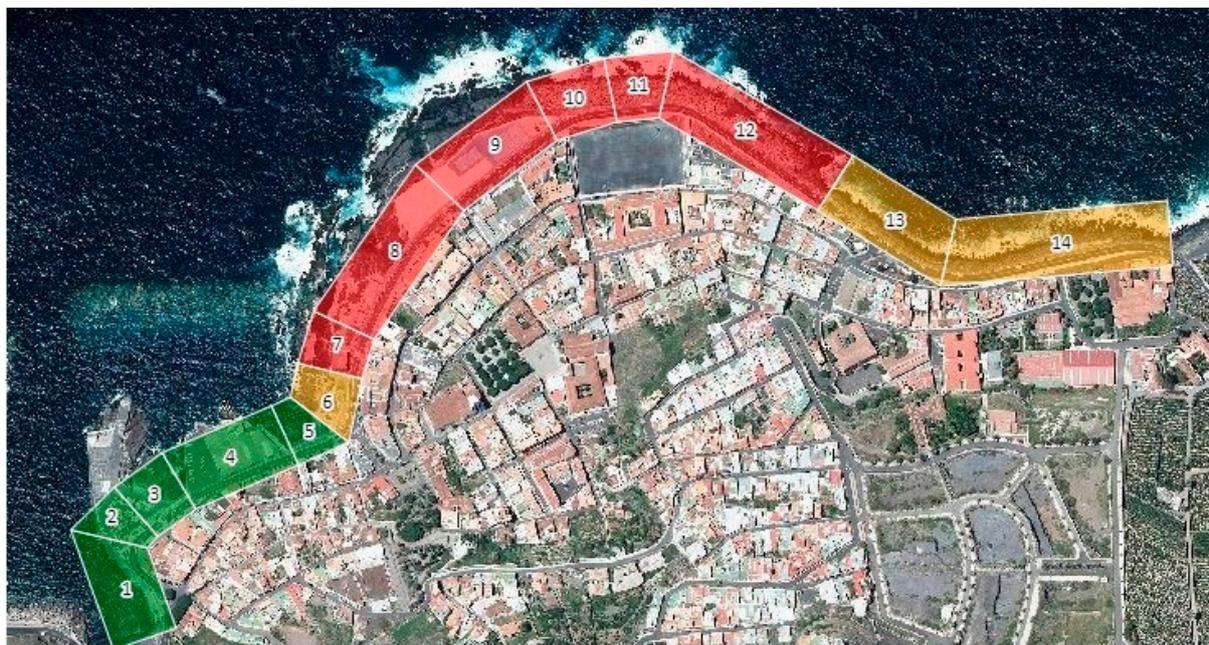
Figura 7. Datos del Sistema de alerta temprana de Garachico (Tenerife) durante la tormenta “Épsilon”. Fuente: Instituto de Hidráulica Ambiental de la Universidad de Cantabria.
