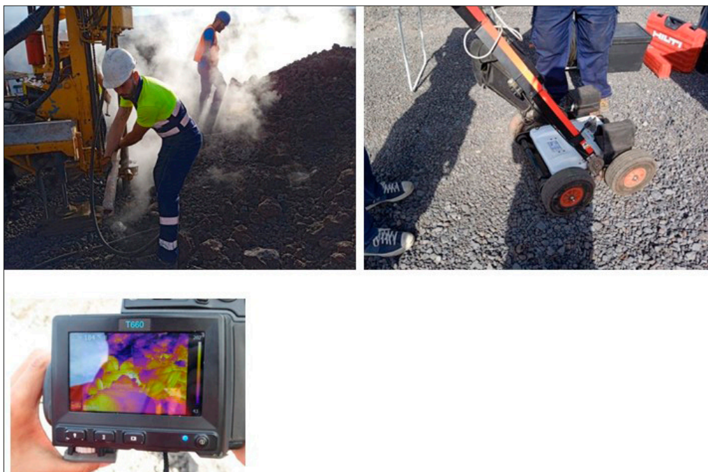
Figura 2. Ejemplos de métodos de investigación in situ realizados en las coladas. Perforación de sondeos en lavas a altas temperaturas. Prospección geofísica con geo-radar. Cámara termográfica utilizada para la medida de temperaturas en superficie.
